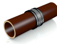
Kupplung mittig über beide Spitzenden schieben und Schösser wechselseitig anziehen.
